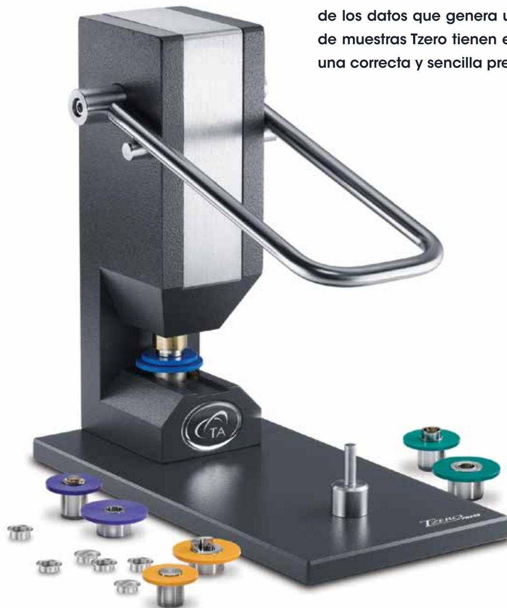
La correcta preparación de las muestras es de vital importancia para la calidad de los datos que genera un DSC. Los recipientes y las prensas de encapsulamiento de muestras Tzero tienen en cuenta cada detalle y están diseñados para garantizar una correcta y sencilla preparación para obtener la mayor calidad de los datos.
