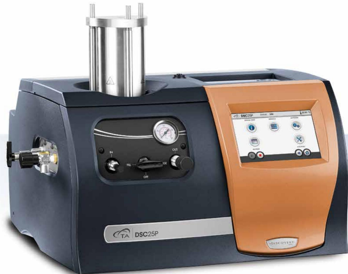
TA Instruments propose un système de DSC sous pression, le Discovery DSC 25P, qui permet de mesurer le flux de chaleur des transitions thermiques, des réactions chimiques, de la stabilité à l'oxydation et de la décomposition sous vide, sous pression atmosphérique, ou à des pressions élevées.
