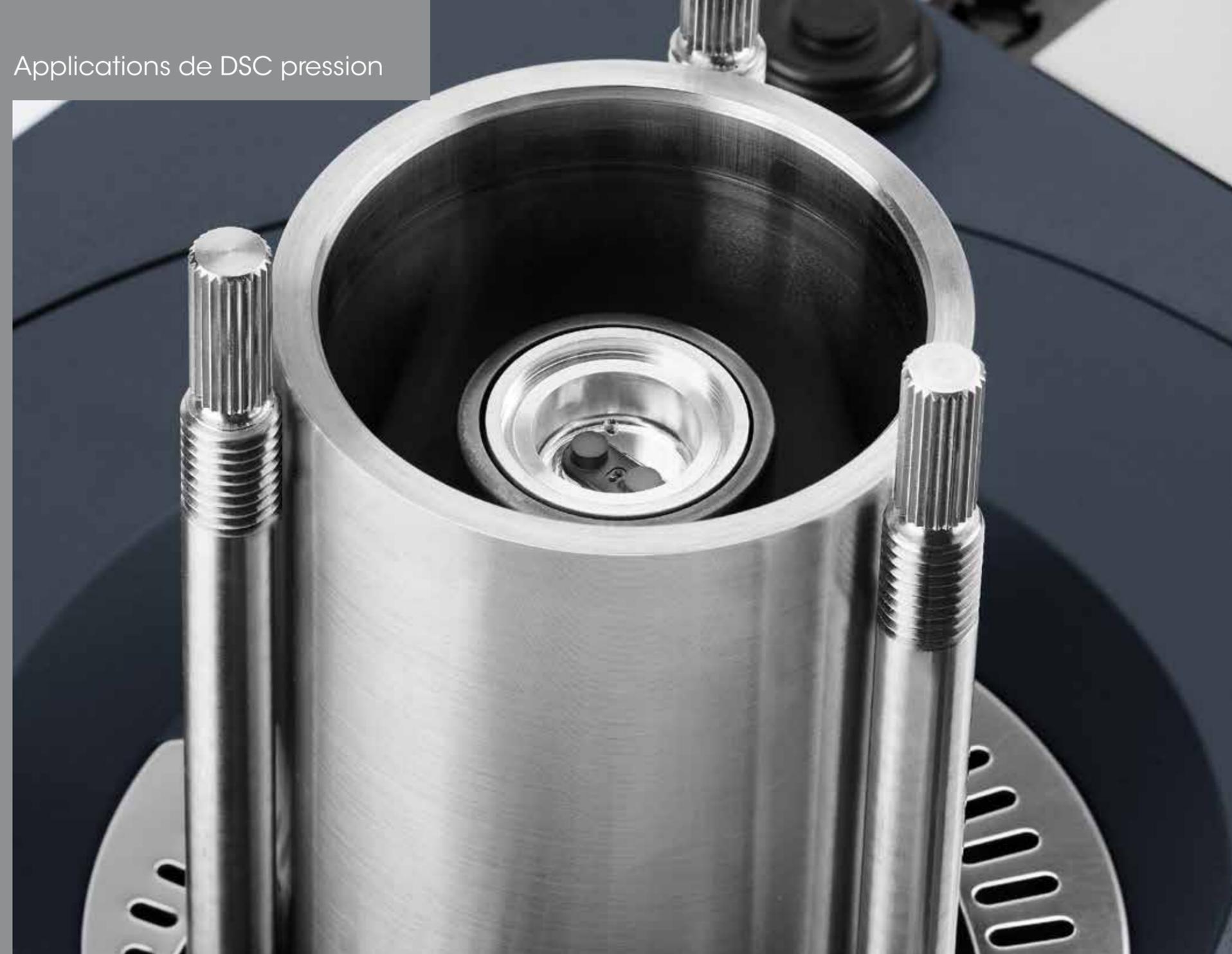
Temps d'induction d'oxydation obtenu par DSC pression
