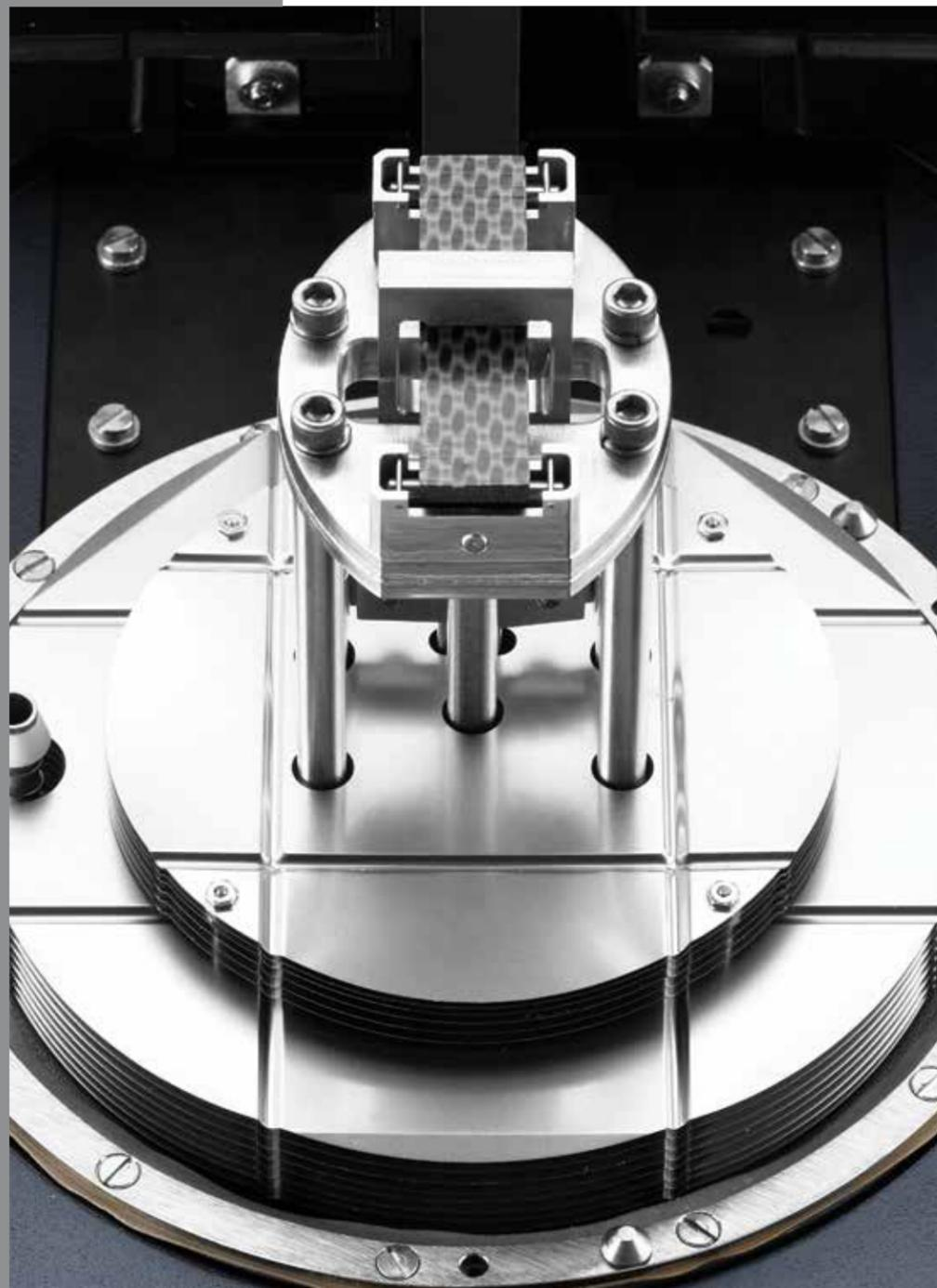
Der DMA 850 verfügt über Probenhalter für alle Verformungsarten, sodass eine breite Palette von Proben analysiert werden und reale Prozess- und Anwendungsbedingungen gut nachgestellt werden können. Die verschiedenen Klemmen sind jeweils für höchste Genauigkeit und optimale Benutzerfreundlichkeit optimiert.
