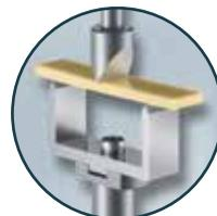
Análisis mecánico dinámico (DMA)
