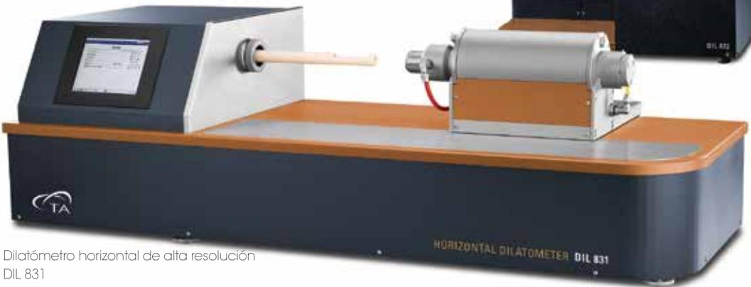
Dilatómetro horizontal de alta resolución
