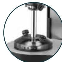
Colector de solvente y sistema bloqueante de la evaporación Peltier
