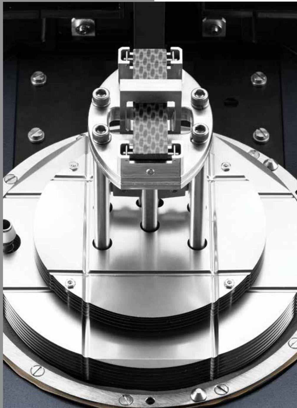
El DMA 850 cuenta con abrazaderas en un conjunto completo de tipos de deformación, de manera que se pueda analizar con precisión un amplio rango de muestras y simular de cerca el proceso o las condiciones de aplicación del mundo real. Cada abrazadera está optimizada para precisión y facilidad de uso.
