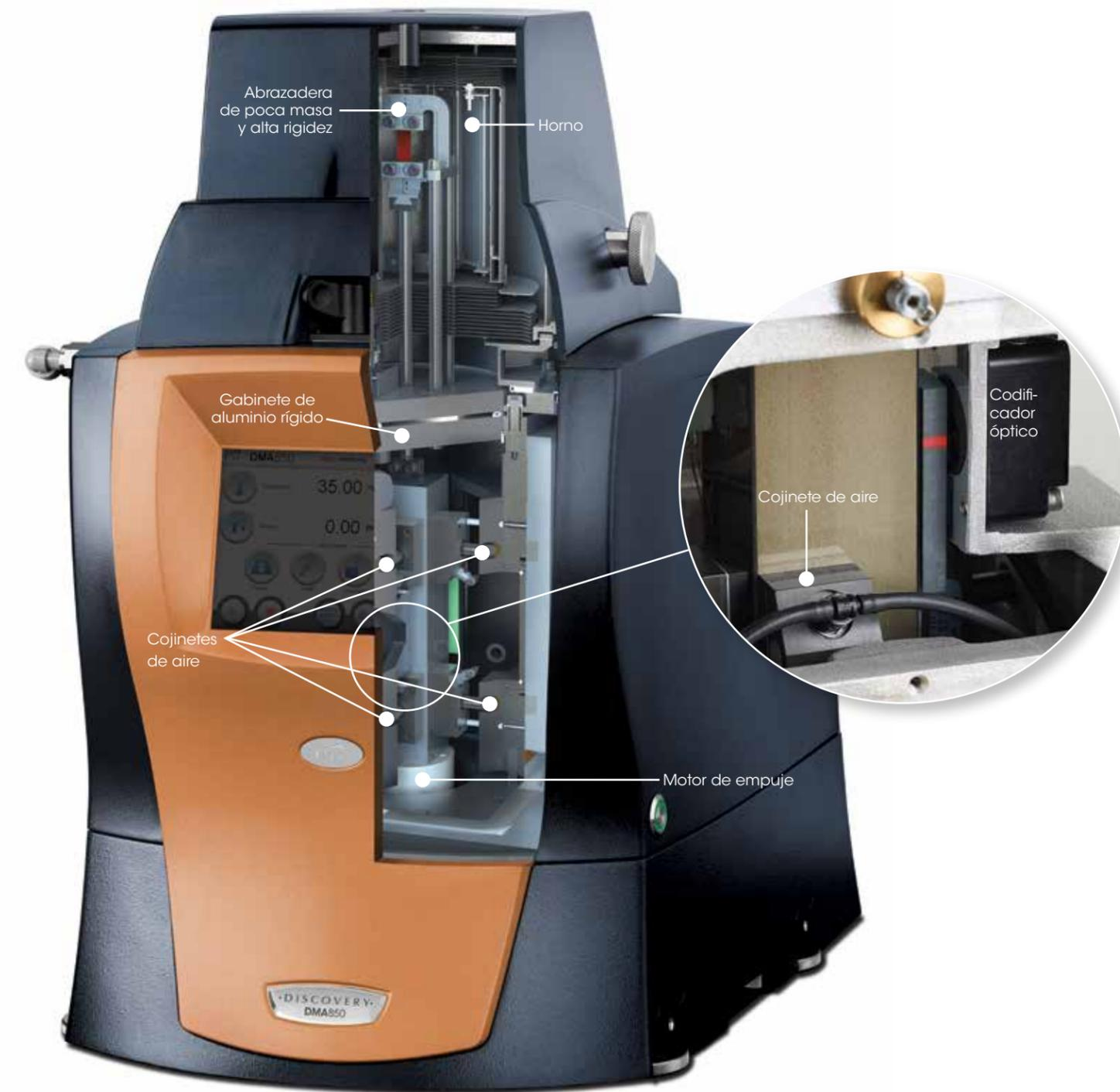
Una medición mecánica precisa se basa en una base que transfiera completamente toda la deformación del motor a la muestra, al mismo tiempo que elimine cualquier influencia de factores externos, como una resonancia del sistema, una variación térmica o una deformación del gabinete.
