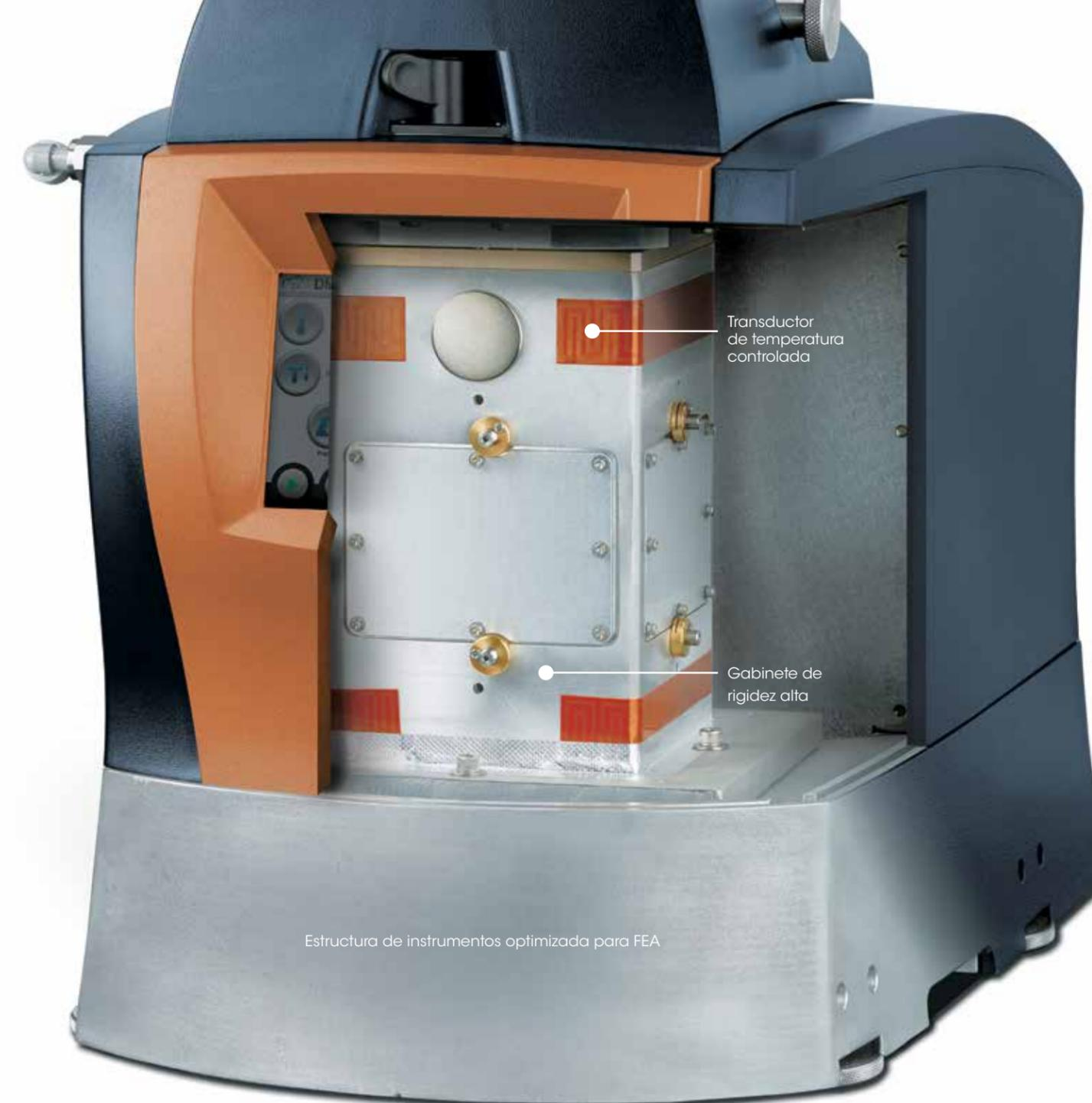
Estructura de instrumentos optimizada para FEA
