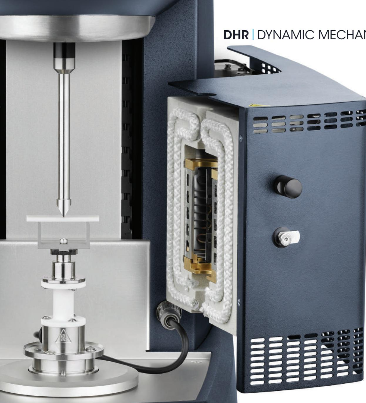
回転型レオロジーおよび線形DMA測定における40年以上にわたるTA インストルメントの専門知識に支持されているDiscovery Hybrid RheometerのDMAモードにより、固体および軟質固体材料の試験に新しい特徴が追加され、DHRは最も高感度で正確な回転式せん断測定に加えて正確な線形動的機械分析(DMA)データを提供できます。制御された軸振動により、引っ張り、曲げ、圧縮の $E'$ 、 $E''$ 、および $\tan \delta$ の直接測定が可能になり、ねじれの固体を含むせん断測定に追加されます。新しいDMAモードは、材料の転移温度の識別に理想的であり、機器の全温度範囲にわたって信頼性の高い測定を提供します。
