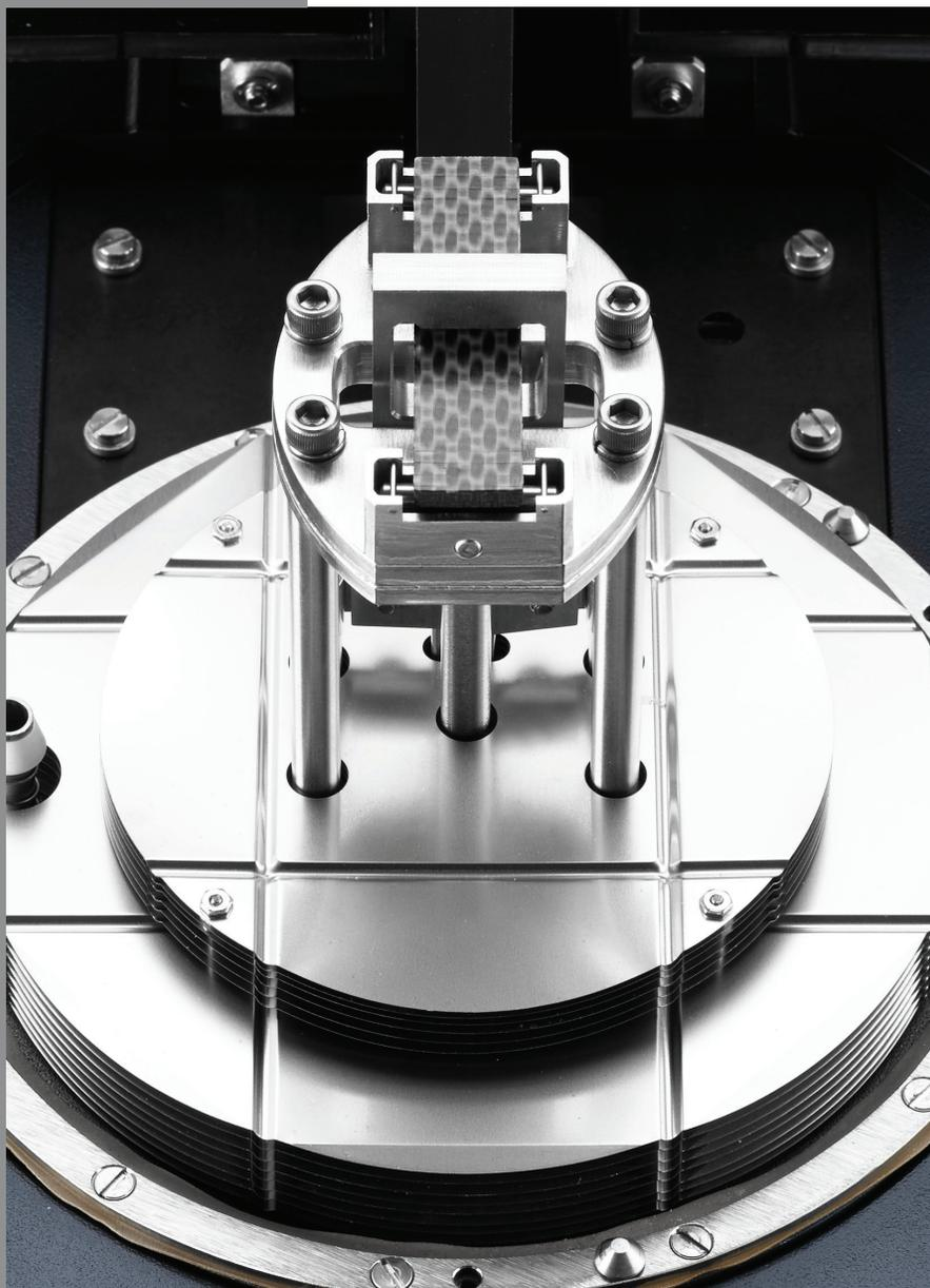
DMA 850はあらゆる変形タイプに対応するクランプを備えており、実際のプロセスや用途条件に近い状態で、様々なサンプルを正確に分析できます。各クランプは、正確性と使いやすさを考慮して個別に最適化されています。
