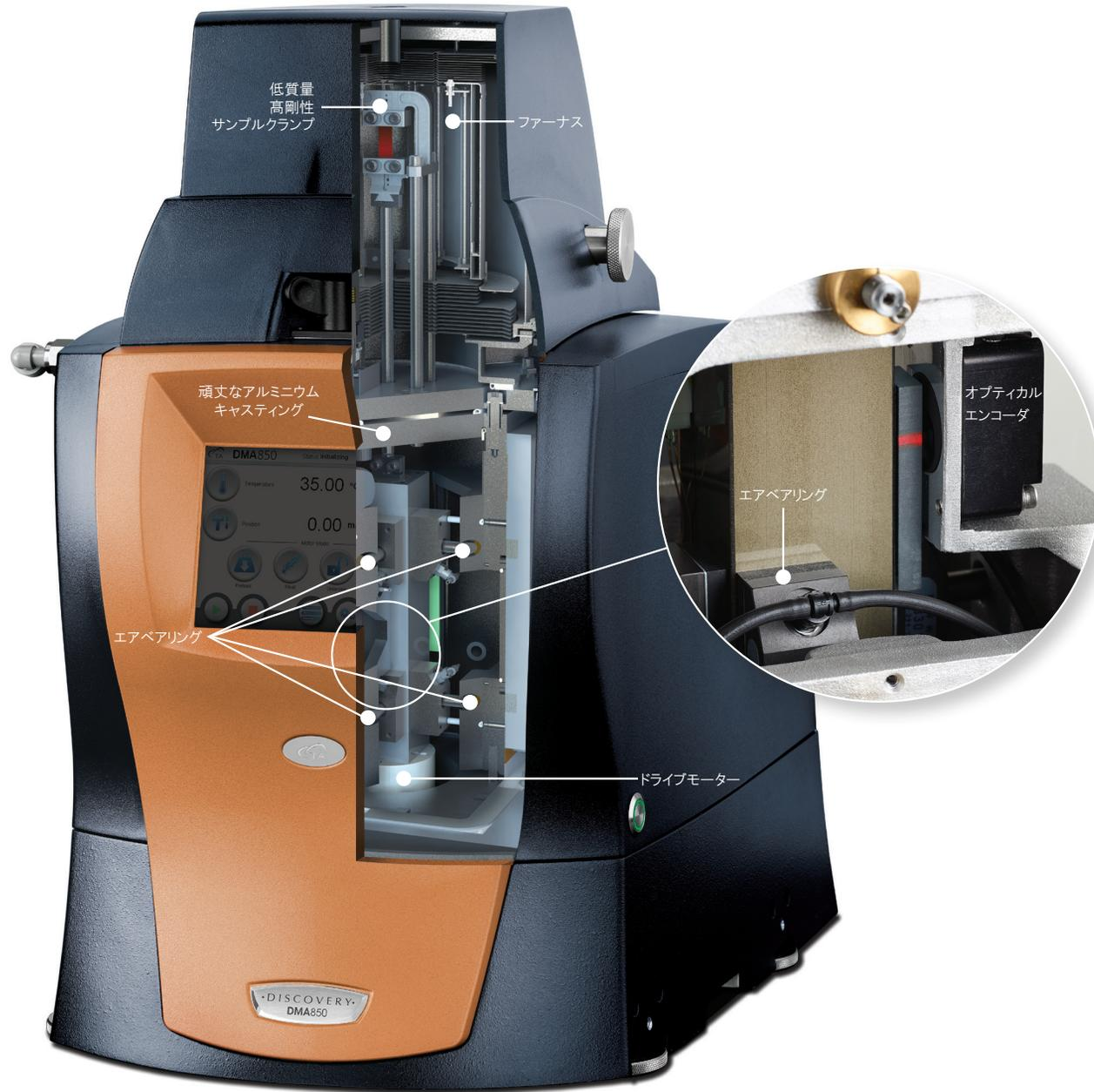
正確な機械的測定は、システムの共振、熱ドリフトまたはフレーム変形などの外部要因による影響を排除すると共に、全てのモーターの変形を完全にサンプルに伝達するという基盤上に構築されます。
