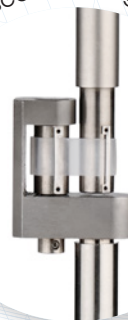
Cellule sous pression haute sensibilité (HSPC)
