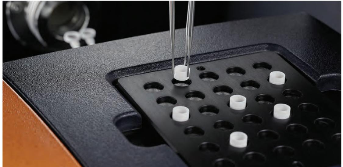
**Das neue Discovery SDT verfügt über unseren neuen Autosampler mit 30 Positionen zur Optimierung der Produktivität. Mit der bewährten Zuverlässigkeit der Konstruktion des Discovery DSC ausgestattet, durchlaufen diese robusten Autosampler unzählige Prüfzyklen in unserem Werk, um einen problemlosen Betrieb zu garantieren.**
