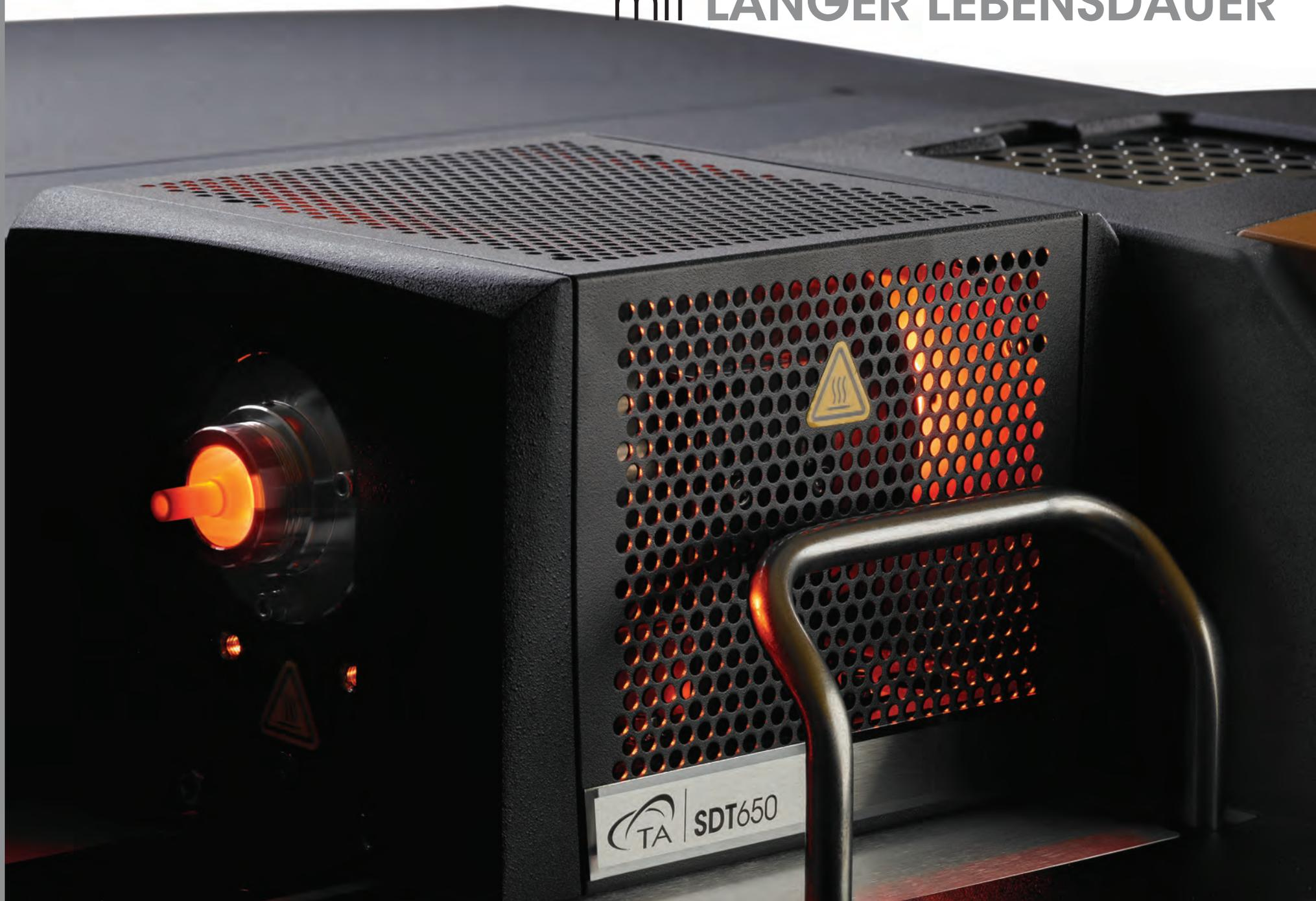
Jeder Ofen wird von TA für jedes System so entwickelt und gefertigt, dass DSC- UND TGA-Hochleistungsmessungen möglich sind. Dieser robuste horizontale Ofen bietet eine höhere Temperaturstabilität als die Modelle anderer Hersteller.
