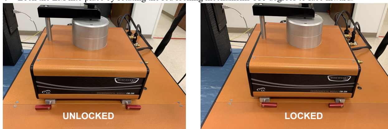
Figure 7 Lock the EM onto the DXF.
