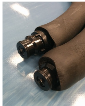
Ein- und Ausgang für Kühlmittel sowie Schläuche
