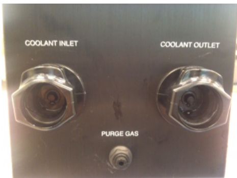
Ein- und Ausgang für Kühlmittel sowie Schläuche
